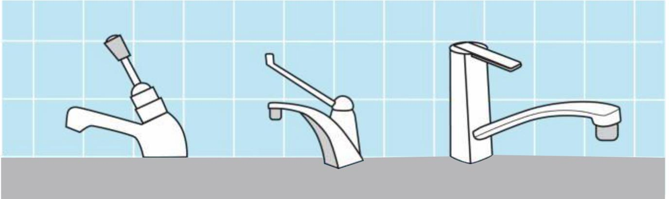
Fig. 73: Ejemplos de tipo de grifería de palanca.
