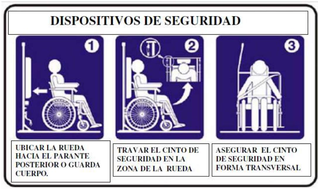
Figura 18 — Orientación sobre la fijación de la silla de ruedas con el cinturón de seguridad
