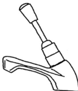
**Figura 3.2.1. Grifería de palanca. Mando y caño monobloque**
